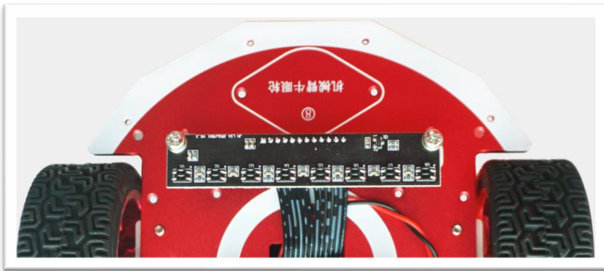
图 1. 循线传感器，位置在机器人的底部
